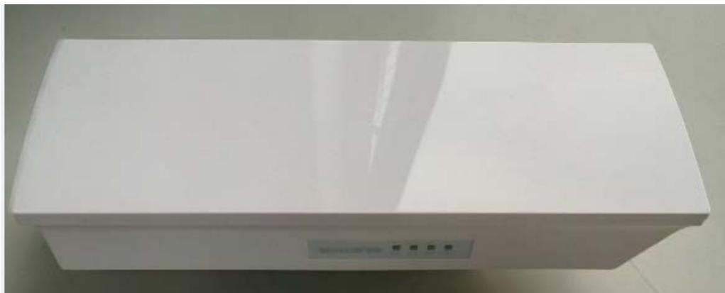
WOP-2425 是一款无线网桥设备，采用 802.11b/g/n 无线传输协议，可以提供高达 300Mbps 的无线接入速率。该产品利用无线传输方式实现在两个或多个网络之间搭起通信的桥梁，内置天线，组网灵活，方便部署。应用于农村，城镇，医院，单位，工厂，小区等无线网络接入，能节省铺设有限网络的费用。
